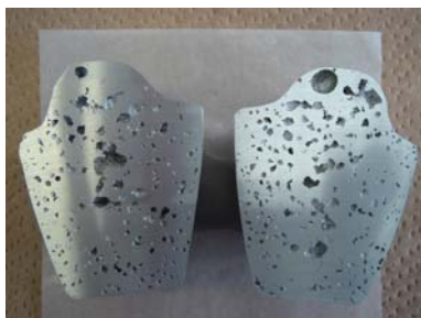
図2 試料切断面(エミリー紙#600研磨後)
